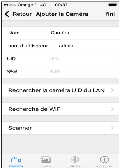
← Geben Sie die UID der Kamera ein oder scannen Sie den QR-Code des Etiketts auf ihrer Unterseite. Drücken Sie auf „Fertig“.
