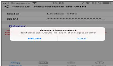
Auf dem Bildschirm wird eine Warnmeldung angezeigt. Drücken Sie auf „Ja“, falls die Kamera weiter piept. Wenn nicht, drücken Sie „Nein“ und setzen Sie die Kamera zurück (Reset).
