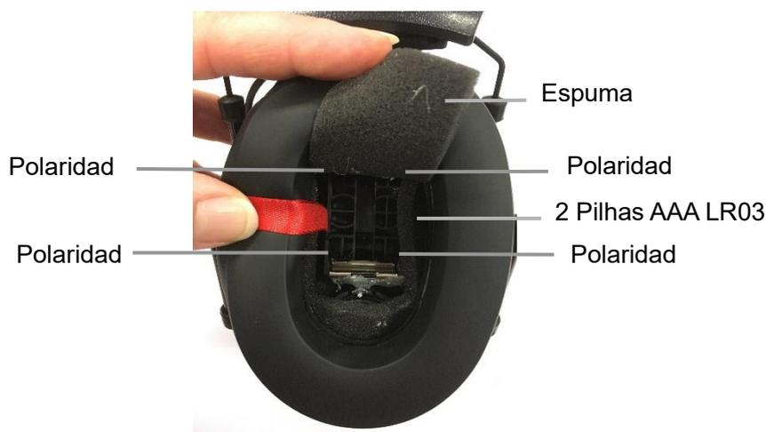
Quando as pilhas estão descarregadas, a luz LED vermelha na concha diminui a intensidade da luz. Quanto mais fracas estiverem as pilhas, menor será a intensidade da luz LED vermelha. Quando as pilhas estiverem gastas, o protetor auditivo deixará de funcionar e os sons exteriores baixos não serão amplificados. Está na altura de substituir as pilhas antigas por pilhas novas. Siga o procedimento indicado no parágrafo anterior.
