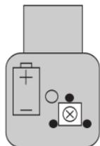
**Attenzione:** il potenziometro di regolazione della sensibilità ha una posizione di arresto fine-corsa. Utilizzate il cacciavite fornito con delicatezza, senza forzare
