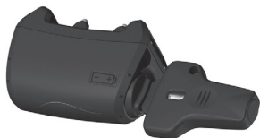
Abb. 4 Einführung der Batterie in das Halsband
