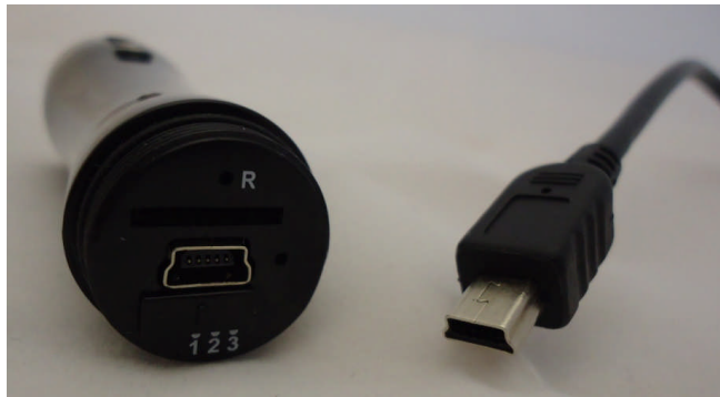
Fig. 1 Port USB pour recharger la caméra
