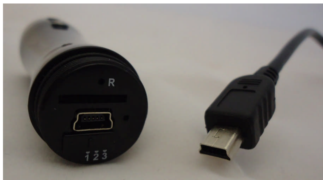
Abb. 1 USB-Port für das Laden der Batterie
