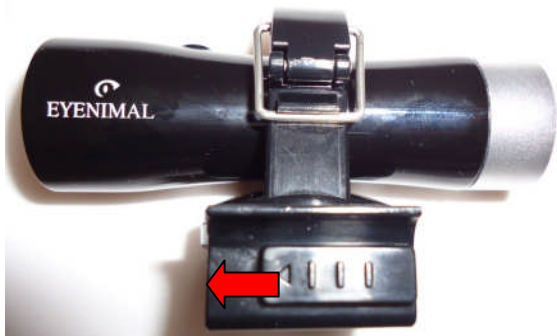
Fig. 3 Abrir el gancho de sujeción
