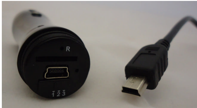
Fig. 1 Porta USB per ricaricare la batteria
