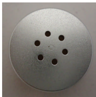
Fig. 11 Bouchon perforé pour enregistrer les sons
