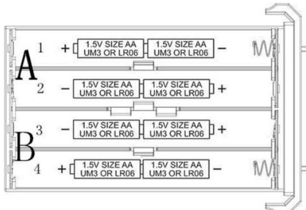
Le voltage du piège photographique est 12V. Pour fonctionner, l'appareil requiert 8 piles AA (LR06).
