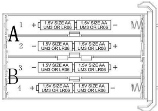
La fototrappola necessita di 8 batterie AA (LR06). Per inserire le batterie premere il pulsante . Inserire le batterie rispettando le polarità indicate. Si possono utilizzare batterie ricaricabili con output 1.5V, alcaline e lithium.
