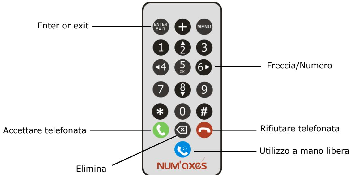
Il telecomando è utilizzato per le impostazioni e per le funzioni telefono. Il range del telecomando è di alcuni metri. Puntare il telecomando verso il fronte della fototrappola.
