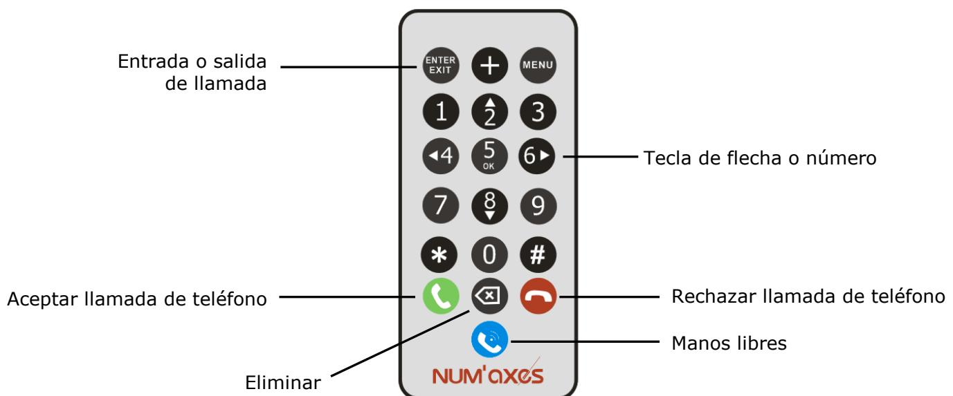
El mando a distancia se utiliza para los ajustes del cliente y la función de teléfono. Se trata de un mando a distancia inalámbrico por infrarrojos y su rango es de unos pocos metros. Apunte con el mando a distancia a la parte delantera de la cámara.
