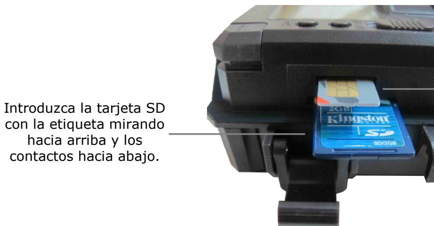
Introduzca la tarjeta SD con la etiqueta mirando hacia arriba y los contactos hacia abajo.
