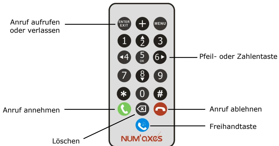
Mit der Fernbedienung können benutzerspezifische Einstellungen vorgenommen und die Telefon-Funktion genutzt werden. Es handelt sich um eine kabellose Infrarot-Fernbedienung mit ein paar Metern Reichweite. Halten Sie die Fernbedienung vor die Fotofalle, damit sie funktioniert.
