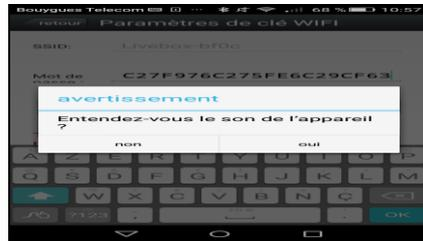
Aparecerá un mensaje de advertencia en la pantalla. Pulse "Sí" si la cámara sigue emitiendo un pitido. De lo contrario, pulse "No" y reinicie la cámara.
