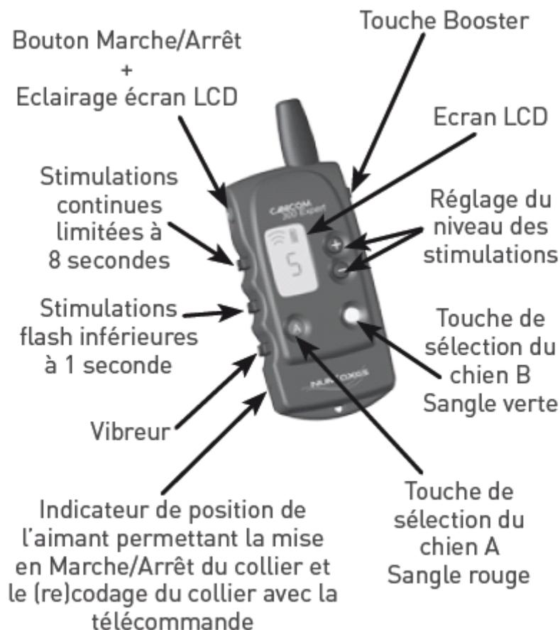
**Fig. 2 - Télécommande CANICOM 300 Expert**
