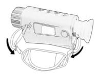
Faites glisser une extrémité de la dragonne à travers le point de fixation puis passer la dragonne dans le passant en plastique.
