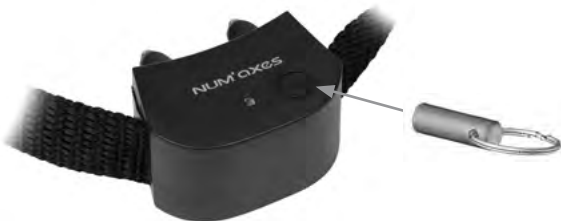
Fig. 6 Mise en/hors service du collier récepteur à l'aide de la clé magnétique
